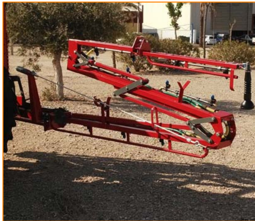
Apertura tipo "Z" barras hidráulicas plegado vertical
