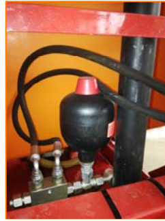
Suspensión de nitrógeno con elevación hidráulica
