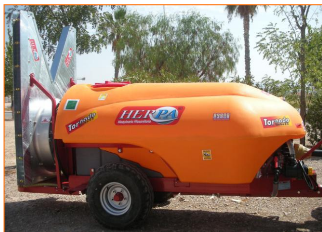
Atomizador Tornado con torre recta y aspiración invertida para cultivos en espaldera
