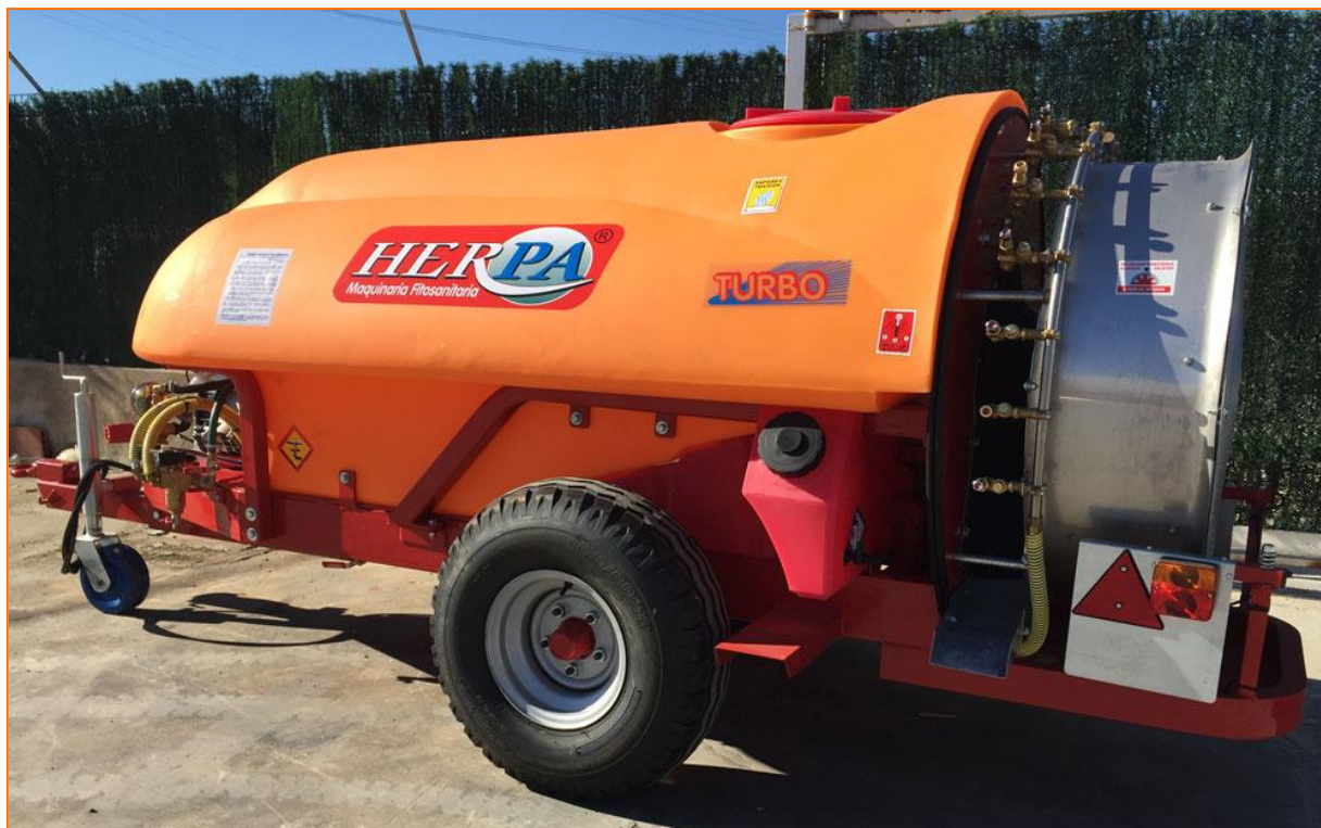
Atomizador Tornado de 1500 L con ventilador de 920 mm de diámetro sin embrague y arco con rango simple de boquillas
