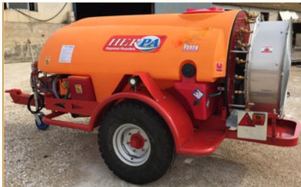
Atomizador "TAMA" de HERPA® con su "SONAR" y configurado con un depósito de 2000 L
