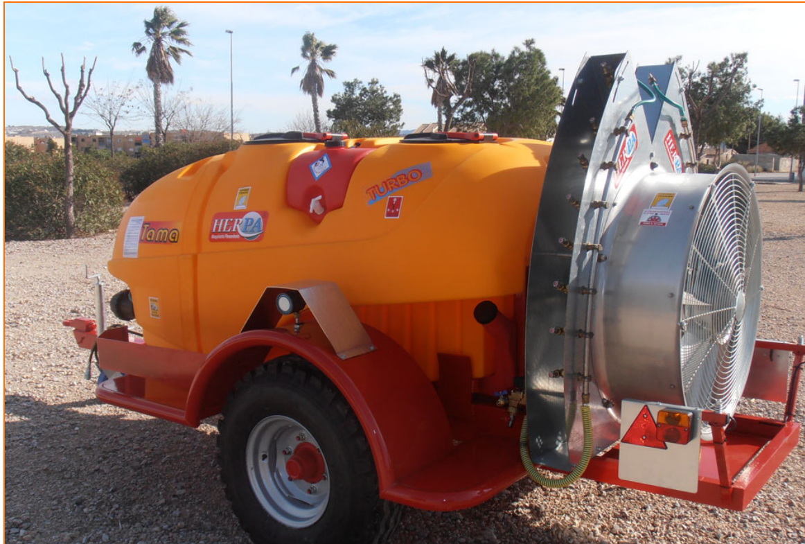
Atomizador "TAMA" de 2000 L con un diseño de depósito diferente con un ventilador de 920 mm de diámetro y una testa especial olivos, componentes igualmente fabricados por HERPA®
