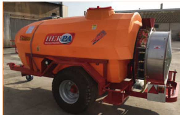
Atomizador "TAMA" de HERPA® se puede también suministrar con un depósito de 4000 L
