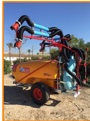
Apertura/cierre manual con ajuste en regla dentada y muelle de retorno o bien sistema hidráulico
