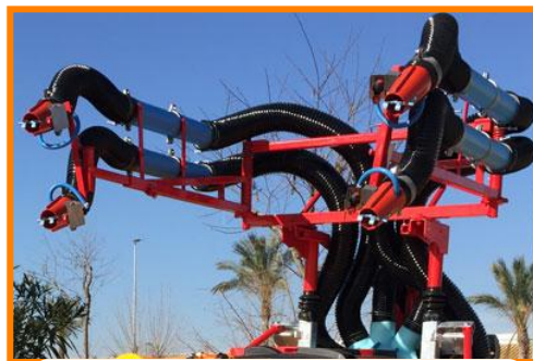
Posición cerrada de la barra manual con una amplitud de solo 1400mm
