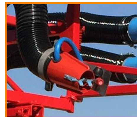
4 cañones con orientación manual o bien sistema eléctrico en opción.
